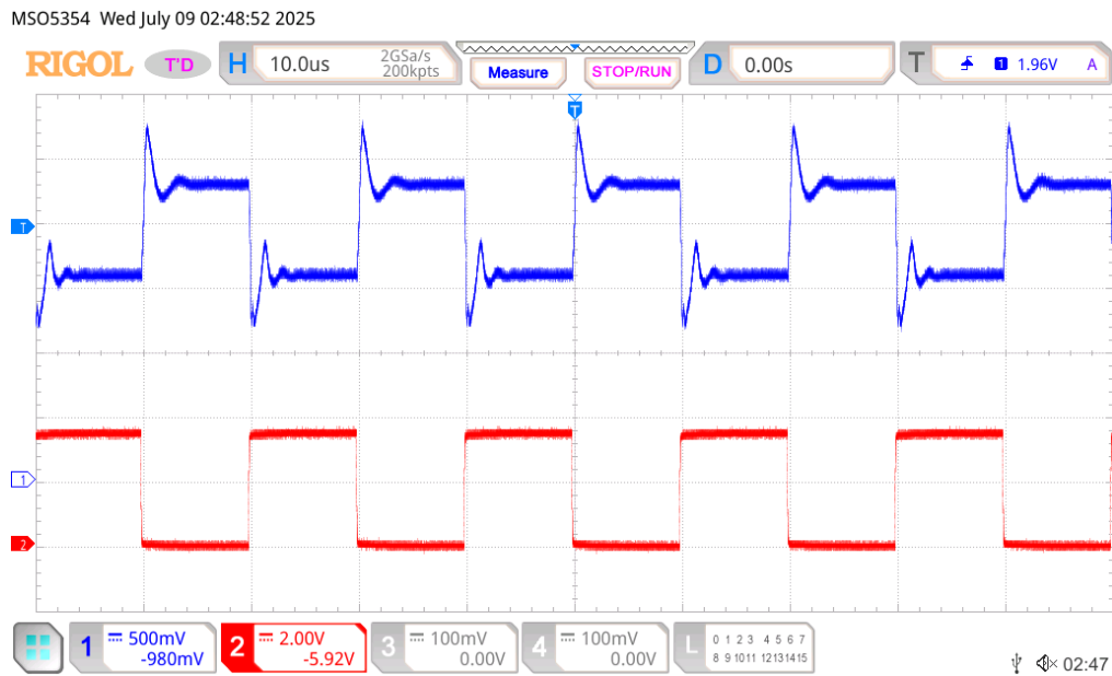
Slika 4.2.5.4: Odziv napona na izlazu kola ( V_{OUT} ) na promjene upravljačkog PULSE signala (50 kHz)
